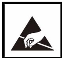
L'installatore deve operare in assenza totale di cariche elettrostatiche già dall'apertura del contenitore, fare attenzione che la scheda elettronica del prodotto può essere danneggiata dalle scariche elettrostatiche.
