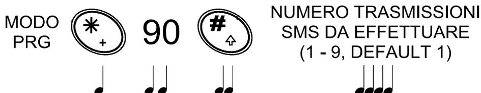
**Nota:** è consigliabile non eccedere sul numero di invii di messaggi SMS data la buona affidabilità dell'invio del messaggio anche se il telefonino dell'abbonato è spento al momento della trasmissione. Il servizio SMS viene effettuato con tempistiche diverse dai vari gestori di rete GSM.
