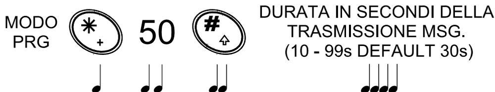
**Nota:** è vivamente consigliato di programmare un tempo di trasmissione consono con le abitudini medie dell'abbonato da chiamare, lo scopo è di evitare che questi arrivi a sollevare la cornetta del telefono allo scadere del tempo di trasmissione.
