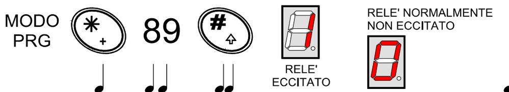
Il display di GSMessenger visualizza lo stato di programmazione per 2s.
