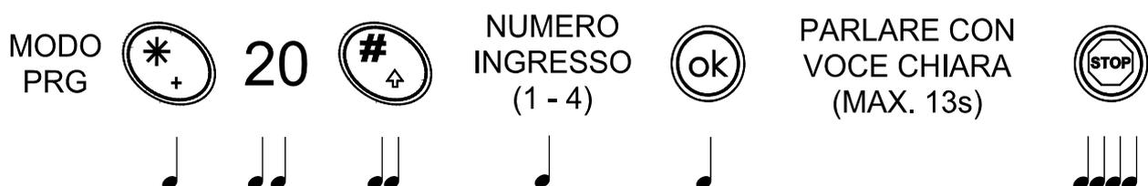
**Nota:** è necessario registrare il messaggio in un ambiente privo di rumore e possibilmente esente da riverbero. Durante la fase di registrazione il display numerico funge da contatore alla rovescia, per i primi 3s propone la lineetta centrale lampeggiante e per i secondi rimanenti verranno proposti con numerazione a decremento.
