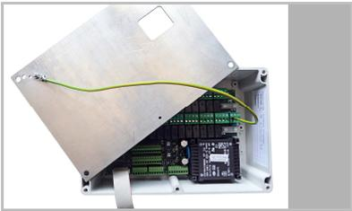
Collegare il collegamento a massa della piastra adattatore alla scheda del WS1000 Color. Il conduttore può essere collegato al terminale PE del collegamento di rete o un gruppo di azionamento libero del WS1000. In alternativa, può essere utilizzato un terminale del conduttore per la messa a terra in loco.
