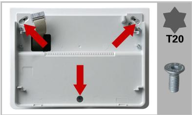
Far passare il cavo del display anche attraverso la cavità della piastra di montaggio a parete del WS100 Color e avvitare la parte inferiore sulla piastra dell'adattatore (3 viti a testa esagonale M4 si trovano sulla piastra dell'adattatore).
