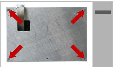
Far passare il cavo del display attraverso la cavità della piastra dell'adattatore e avvitare la piastra alle cassette UP della centralina.
