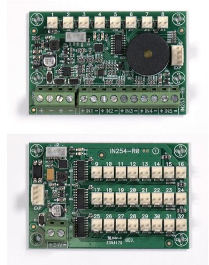
Il modulo EM500 permette all'installatore di creare un pannello sinottico, utilizzando un pannello sul quale è applicata una mappa dell'edificio monitorato facendo dei fori nei punti della mappa dove sono locate le zone e applicandovi i LED con i cavetti forniti.
