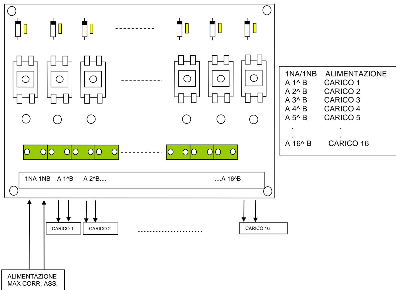
Il circuito di distribuzione carichi C1F16 e' stato progettato per ripartire la corrente assorbita ai morsetti d'ingresso su 16 uscite parallelate verso 16 carichi. Ciascuna uscita è dotata di fusibile di protezione, diodo antiricircolo contro l'inversione di polarità e segnalazione a LED per l'interruzione del relativo fusibile. Per i limiti di funzionamento del circuito riferirsi alle caratteristiche tecniche di seguito riportate.
