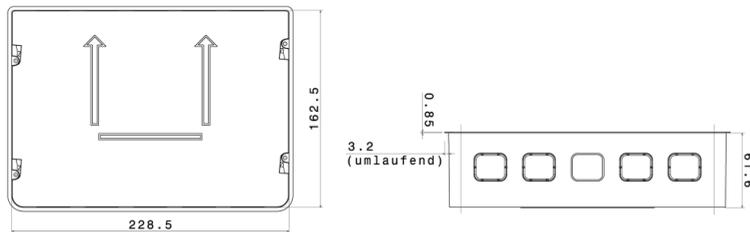
Per potenziare la comunicazione radio potrà essere collegata un'antenna esterna. Durante l'installazione, predisporre a tal fine sotto la scatola da incasso, **una canalina da 50 cm** per il contenimento dell'antenna esterna (dimensione totale dell'antenna ca. 565 x 8 x 5, L x W x H in mm):
