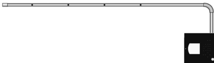
Figura 2-1: Rete a tubazione singola
