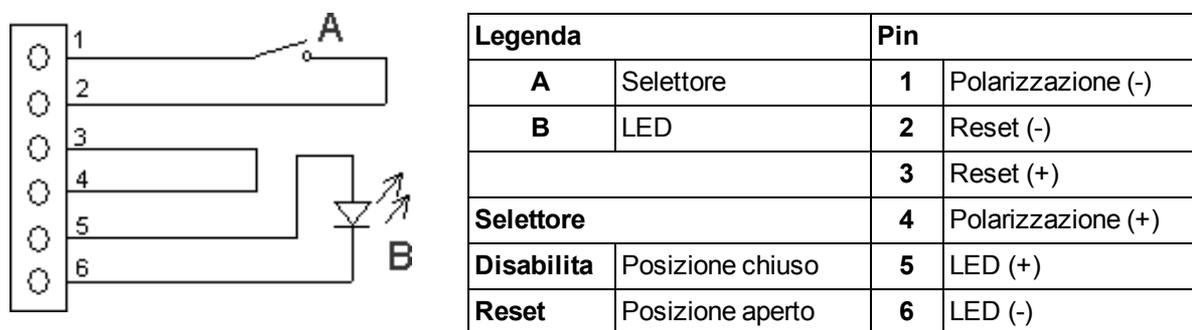
Figura 3-2: Collegamento dei morsetti GPI / ausiliari
