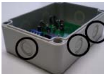
Fig. 3 - Fori ciechi "a rottura" per l'ingresso dei cavi
