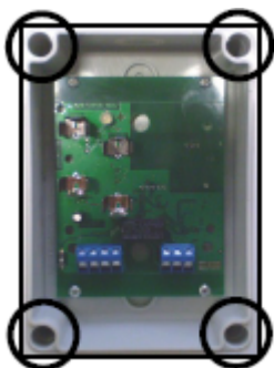
Fig. 2 - Fori per l'inserimento delle viti di fissaggio
