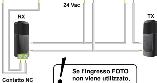
**!** Se l'ingresso FOTO non viene utilizzato, porre in ON il DIP2B
