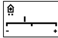
Fig. 5 Indicazione della modalità con indicazione della scala per la variazione del valore nominale di base. L'impostazione della regolazione nell'immagine mostra "Valore nominale di base ridotto".
