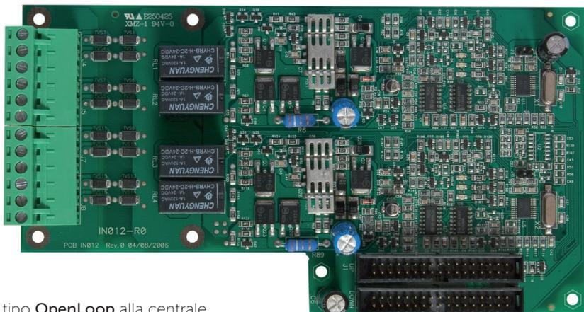
Ciascuna scheda di espansione aggiunge 2 loop di tipo **OpenLoop** alla centrale offrendo così la possibilità di espandere ciascuna centrale fino ad un massimo di 8 loop.
