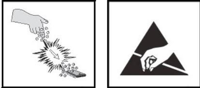
L'installatore deve operare in assenza totale di cariche elettrostatiche già dall'apertura del contenitore, fare attenzione che la scheda elettronica del rivelatore può essere danneggiata dalle scariche elettrostatiche.
