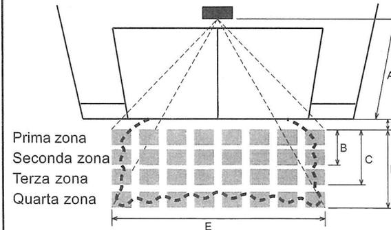
Una volta eseguita la regolazione, raccomandiamo di riaccendere il sensore e controllare in pratica la correttezza delle varie zone di rilevamento impostate.
