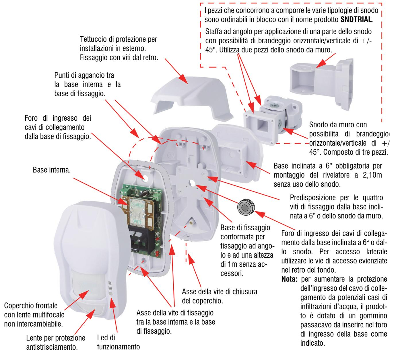
**Nota:** gli snodi sono forniti con il prodotto **SNDTRIAL** sono da montare secondo necessità e sono dotati in particolare di rondelle in gomma speciale con funzione di frizione. Per l'assemblaggio consultare lo specifico foglietto informativo.
