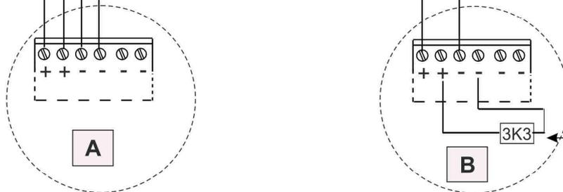
Resistenza di fine linea da 3K3Ω da collegare all'uscita dell'ultimo dispositivo installato, anche se presente uno solo
