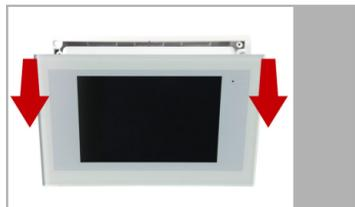
L'unità di visualizzazione viene fissata alla cassetta da incasso con magneti. Togliere la parte anteriore.
