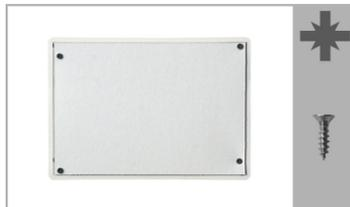
Per incasso, avvitare con le viti a disposizione la protezione (cartone) alla cassetta da incasso.
