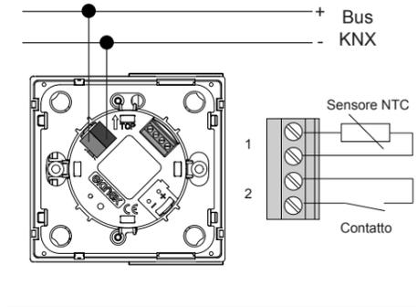
**!** *Avvertenza! Il collegamento a un ingresso di un dispositivo non corrispondente alla configurazione dei parametri di prodotto eseguita con ETS causa l'impossibilità di svolgere la funzione desiderata.*
