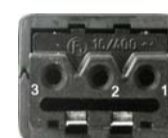
Abb. 3b: Collegamento Motore 1: N | 2: Verso alto 3: Verso il basso PE: ⚡
