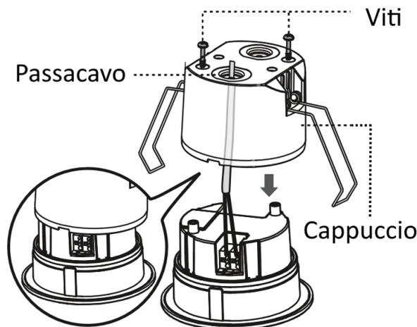
Per inserire il dispositivo nel foro sul pannello del soffitto, sollevare e trattenere i fermagli a molla; guidarli nel foro e far scorrere delicatamente il corpo del sensore fino a quando non cade in posizione.
