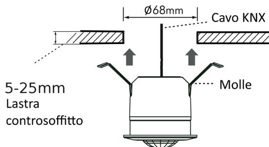
Per rimuovere il sensore, togliere la ghiera esterna e fare leva delicatamente sotto il bordo esterno con un cacciavite o un altro oggetto piatto; una volta che si riesca ad afferrare saldamente il bordo con le mani, tirare delicatamente ma con fermezza per estrarre il corpo del sensore.
