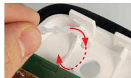
Posizionare la batteria sui punti d'appoggio dedicati. Fissare stabilmente la batteria stringendo la fascetta. Inserire la porzione di fascetta in esubero dove indicato.
