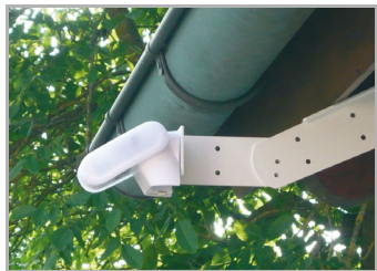
Fig. 8 Esempi di applicazione del braccio articolato: Per mezzo del braccio articolato, la stazione meteorologica sporge dalla copertura della cornice di gronda. Ciò permette l'azione non ostacolata del sole, vento e precipitazioni sui sensori.
