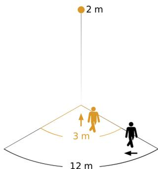
Possibile altezza di montaggio: 1,80 m - 3,00 m
