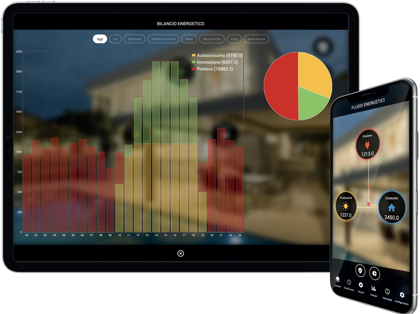
L'efficiente algoritmo di controllo carichi integrato, si occupa di mantenere sotto controllo i consumi energetici, spegnendo automaticamente gli elettrodomestici - seguendo un ordine di priorità modificabile in ogni momento - per evitare il distacco del contatore per superamento della potenza contrattuale.
