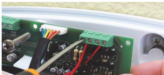
Procedere alla rimozione dei cavi di collegamento segnandoli appropriatamente per il successivo cablaggio. Sostituire la scheda con una nuova e ricablare correttamente
