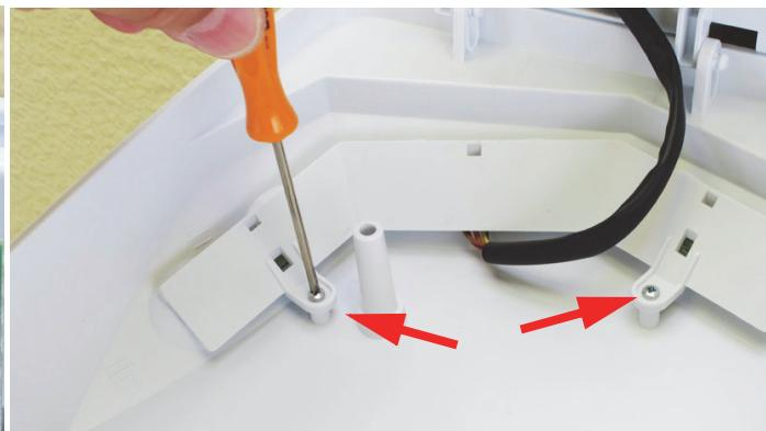
Spostare il cavo di collegamento che passa tra le due trombe, rimuovere le viti di fissaggio della scheda in plastica che incorpora i segnalatori a led e sostituirla con una nuova fissandola con le viti.
