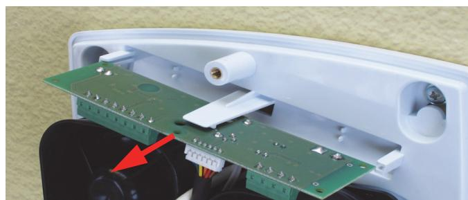
Girare la scheda elettronica, inserire la linguetta di blocco nel foro rettangolare e bloccarla alla torretta utilizzando la vite del coperchio interno.
