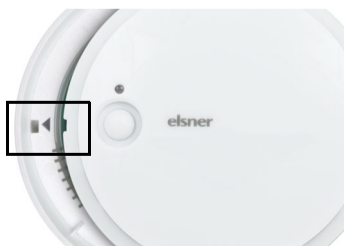
Fig. 7 Chiudere l'alloggiamento inserendo il coperchio e facendolo incastrare. Allineare l'incavo sul coperchio alla marcatura nello zoccolo (il sensore di presenza deve sporgere attraverso l'apertura nel coperchio).
