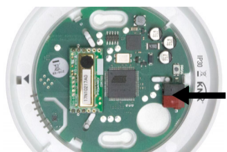
Fig. 6 Collegare il bus KNX al morsetto KNX.
