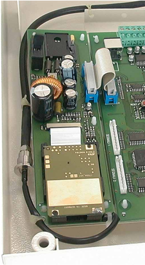
Cable exit path (ETR)
