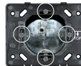
Fig. 2 Avvitare l'unità di montaggio alla scatola. La freccia ("TOP") deve essere rivolta verso l'alto. Sono sufficienti due viti (dx/sx oppure sotto/sopra).
