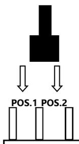
**POS.1:** Il trasmettitore funziona in **MODALITA' PASSO PASSO**. Il tasto memorizzato esegue la funzione **APRE,STOP,CHIUDE,STOP**.
