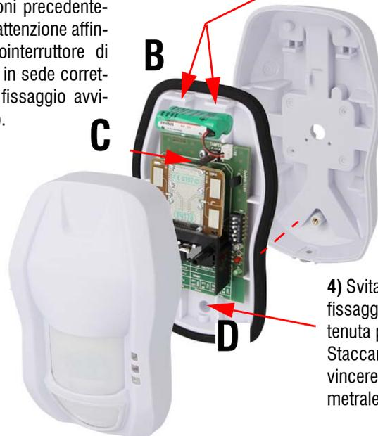
4) Svitare la vite indicata con **D** dalla freccia per fissaggio della base interna con guarnizione di tenuta perimetrale e il circuito del rivelatore. Staccare la base interna con forza sufficiente a vincere l'attrito della guarnizione di tenuta perimetrale. Separare la base di fissaggio.
