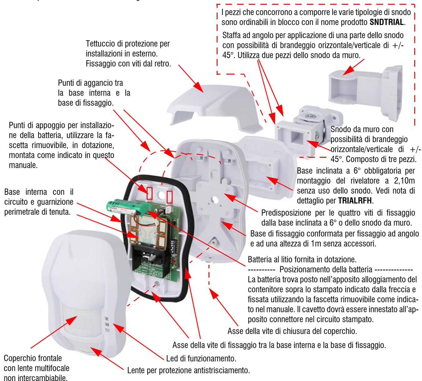
**Nota:** gli snodi sono forniti con il prodotto **SNDRTRIAL** sono da montare secondo necessità e sono dotati in particolare di rondelle in gomma speciale con funzione di frizione. Per l'assemblaggio consultare lo specifico foglietto informativo.
