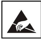
L'installatore deve operare in assenza totale di cariche elettrostatiche già dall'apertura del contenitore, fare attenzione che la scheda elettronica del rivelatore può essere danneggiata dalle scariche elettrostatiche. Le accortezze devono essere osservate durante la fase installativa e durante una manutenzione.
