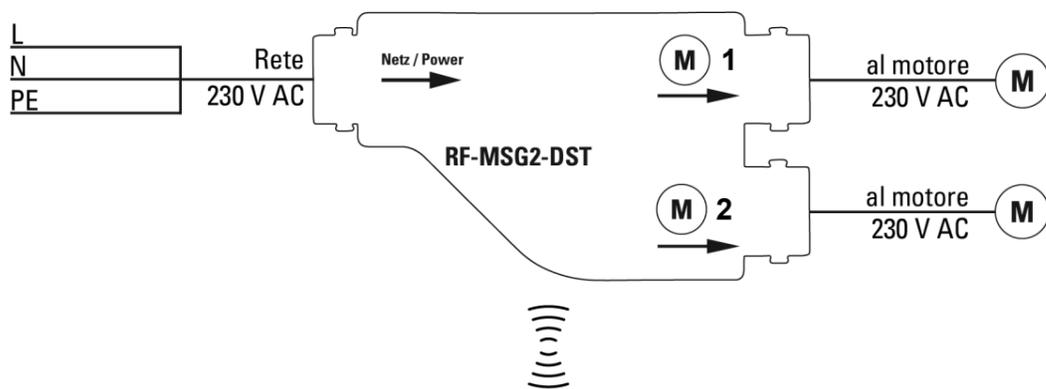
Comunicazione radio con comando remoto o centralina di comando edificio
