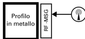
Il simbolo dell'antenna sull'alloggiamento indica la posizione della stessa sul **RF-MSG2-DST**. Questo lato non deve essere collocato direttamente sulle superfici od oggetti in metallo. Il segnale radio potrebbe essere disturbato.
