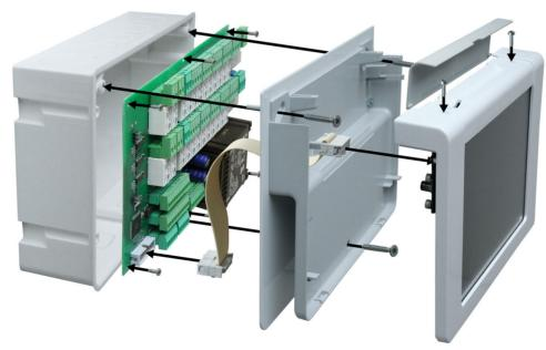
Una volta eseguito il cablaggio, avvitare il fondo della scatola (con la piastra di montaggio) sulla cassetta da incasso. Attaccare poi la piattina multipolare al display.
