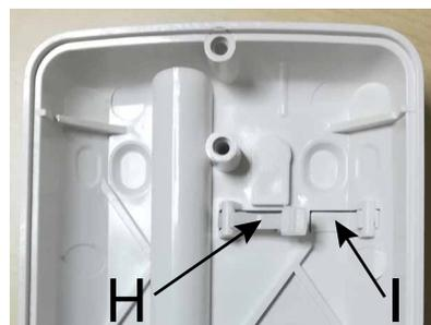
Nel caso di montaggio ad angolo, per usufruire della protezione contro lo strappo dal muro è necessario spostare la levetta H (che agisce sul microinterruttore relativo presente sul retro della scheda) al posto del tassello in plastica I che chiude l'angolo del sensore.
