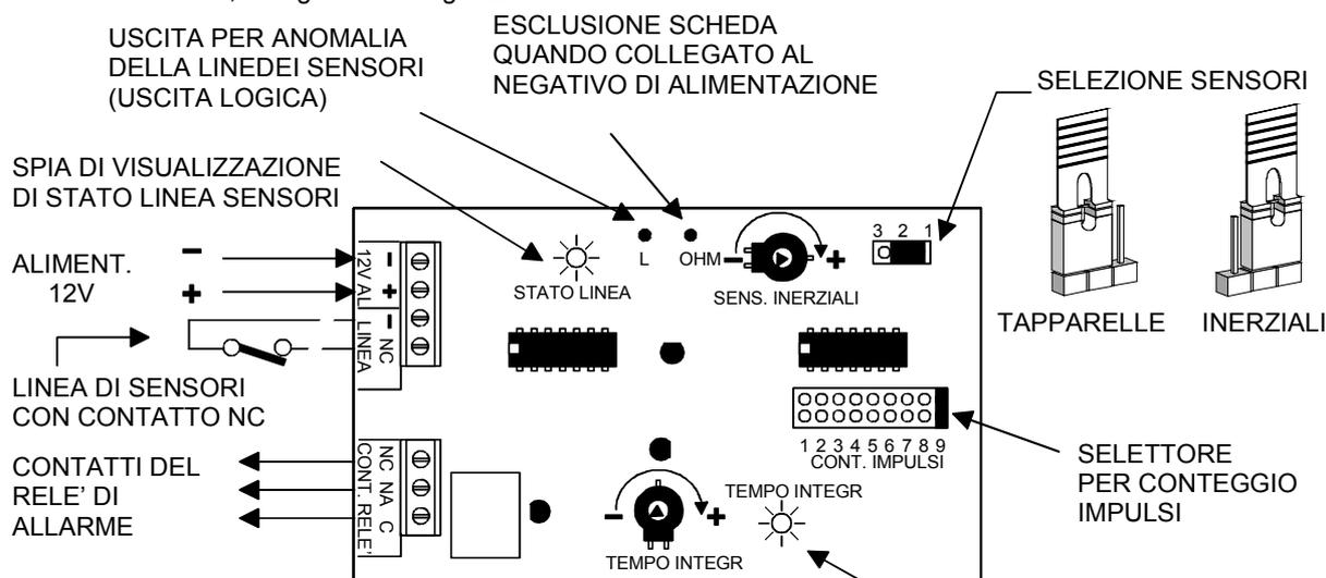
Usare per il collegamento del sensore remoto solo cavo schermato con lo schermo collegato al negativo di alimentazione dal lato centrale o scheda CA/SI
