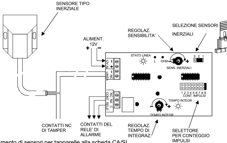
Schemi di collegamento di sensori per tapparelle alla scheda CA/SI
