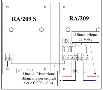
Collegamento di un rivelatore di liquidi RA/209 con sonda supplementare RA/209 S ad una interfaccia MI/410 connessa ad un linea di rivelazione indirizzata analogica, CENTRALI serie MIPRO / AREA 54
