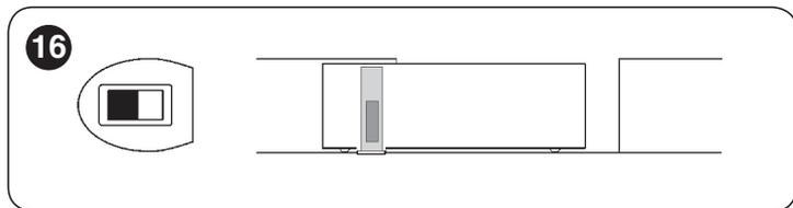
Se per l'apertura l'anta deve muovere a destra occorre spostare il selettore a destra come in "Figura 17".
