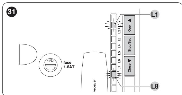
2. premere il tasto **[Open ▲]** o **[Close ▼]** per spostare il led lampeggiante sul "**L8**", cioè il "led di entrata" per il parametro "**Elenco anomalie**"
