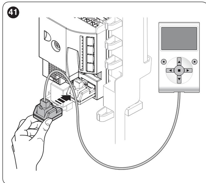
L'Oview può essere collegato a più centrali simultaneamente (fino a 5 senza particolari precauzioni, fino a 60 seguendo le apposite avvertenze) e può restare collegato alla centrale anche durante il normale funzionamento dell'automazione. In questo caso, può essere utilizzato per inviare direttamente i comandi alla centrale utilizzando lo specifico menù "utilizzatore".
