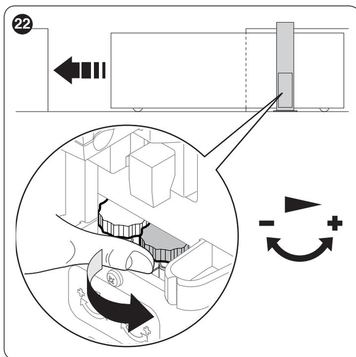
4. quindi, sulla centrale premere nuovamente il tasto [Open ▲] oppure [Close ▼] per comandare l'apertura o chiusura dell'anta per registrare la nuova posizione. Se necessario, ripetere l'operazione fino a quando l'anta raggiunge il finecorsa desiderato.
